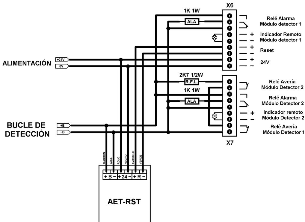
**1.7 CONEXIÓN A PANEL DE EXTINCIÓN AE/PX2.**
