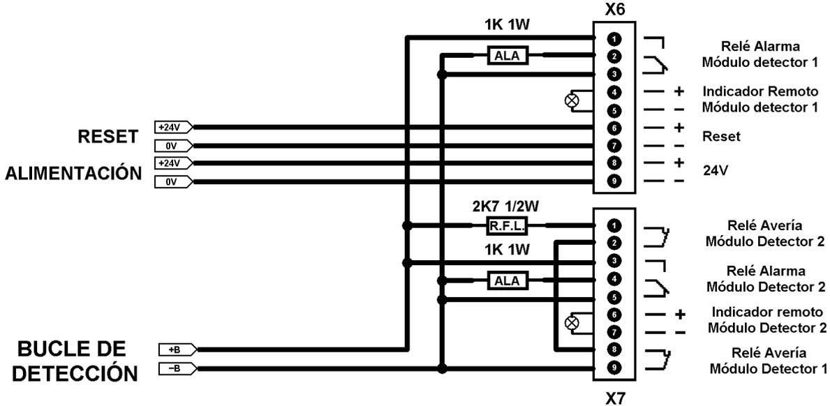
1.6.3 CONEXIÓN A BUCLE DE DETECCIÓN CONVENCIONAL CON MÓDULO DE REARME AET-RST.
