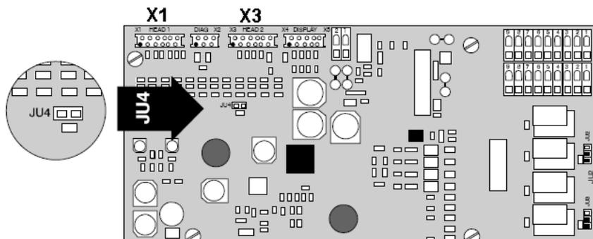
La configuración del modo de funcionamiento del módulo detector se realiza mediante selectores.
