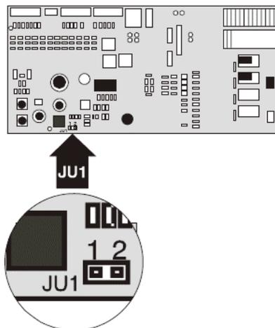
☞ Una vez modificada la tensión de funcionamiento del ventilador, debe realizarse el proceso de ajuste del flujo de aire. La posición del selector JU1 solo debe cambiarse con el detector TITANUS Pro-Sens TP1 sin alimentación.
